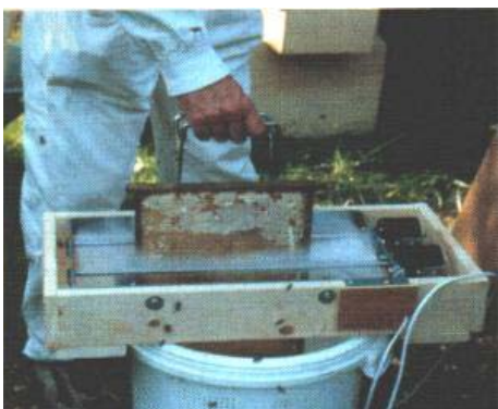
Honigernte Honigernte mit der Abkehrmaschine: Die rotierenden Walzen fegen die Bienen sanft von der Wabe. Sie sammeln sich im Hobbock, der mit Lüftungslöchern ausgestattet ist
